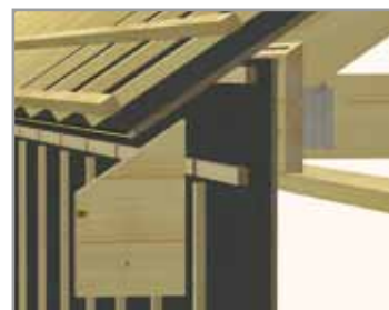
D10. Overgang vegg/tak med løst utstikk
